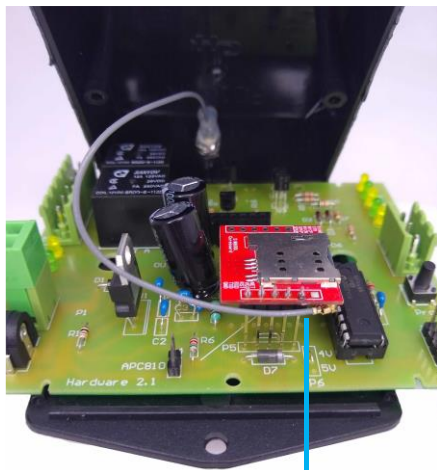
Cable de la Antena
